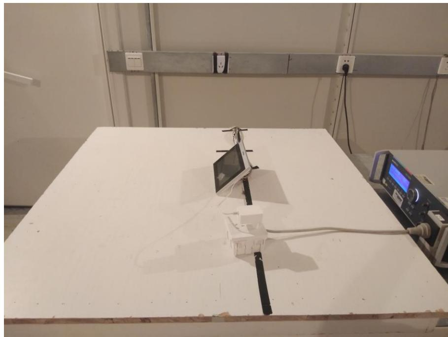
**EFT Test Setup Photo-ISN**
